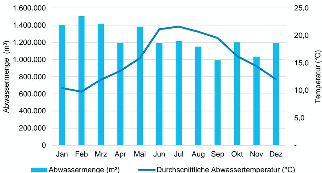
Abbildung 17: Durchflussmengen und Temperaturen des Abwassers
